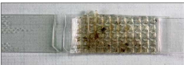
Рис. 4. Руїнування ультразвукового напускного зварного шва під час випробувань на розтяг
