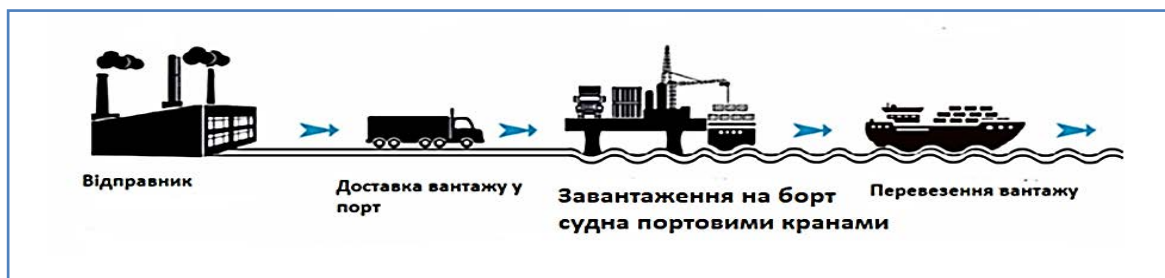
Рис. 7. Технологічна схема обробки штучного вантажу масою від 25 тонн до 40 тонн за допомогою портових вантажних засобів. Якщо маса перевищує 40 тонн, то застосовується парна робота кранів вантажопідйомністю до 70 тонн за прямим варіантом
