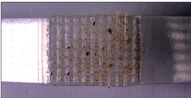
Рис. 3. Ультразвуковий напускний зварний шов біорозкладної плівки, виконаний сонотродом із профільованою поверхнею
