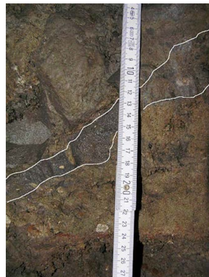
Рис. 7. Прошарок пульпи над залізобетонною плитою фундаменту
